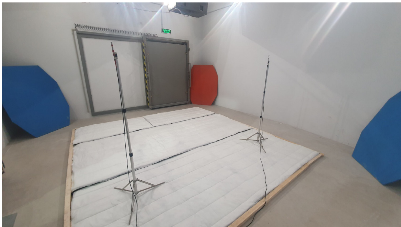
Рисунок 3 – Исследуемый образец №3, смонтированный на полу реверберационной камеры
