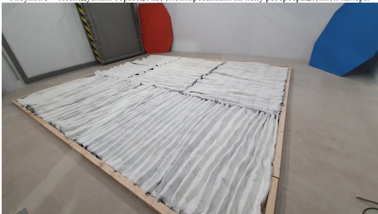
Рисунок 3 – Исследуемый образец №4, смонтированный на полу реверберационной камеры
