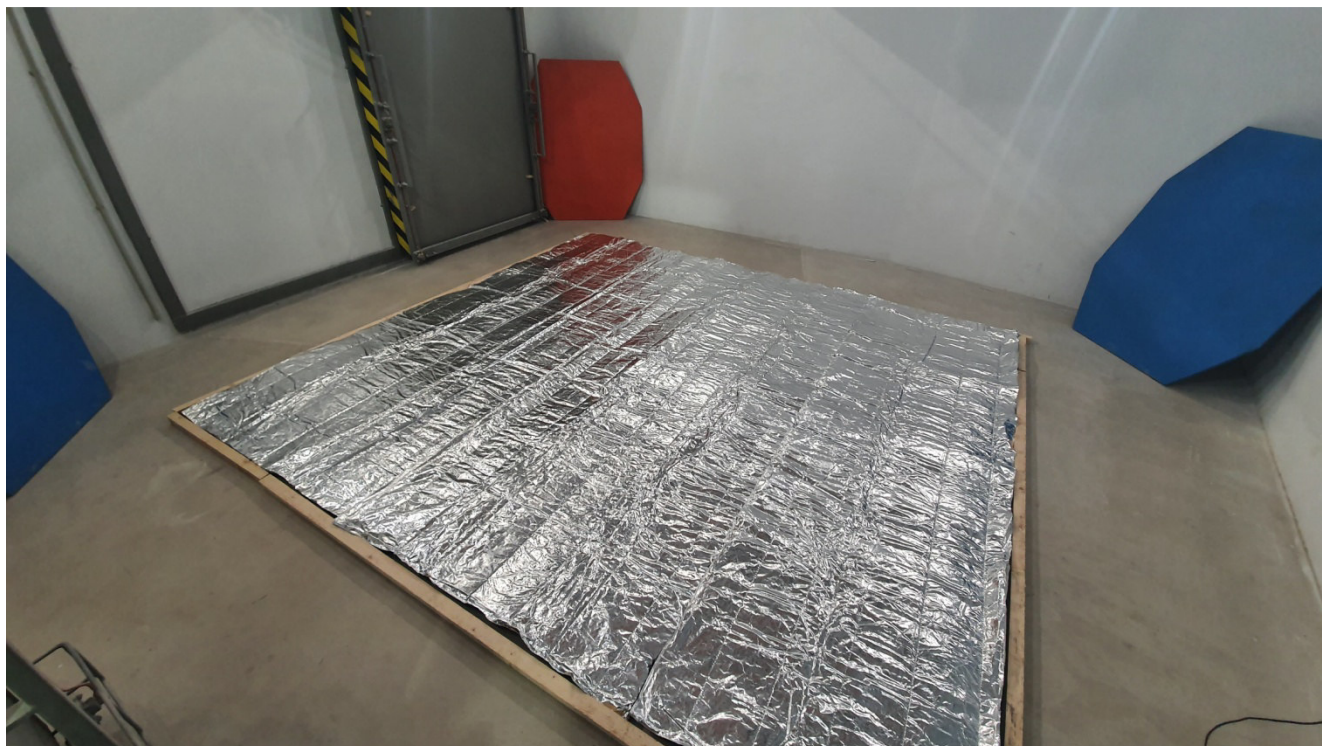
Рисунок 1 – Исследуемый образец №1, смонтированный на полу реверберационной камеры
