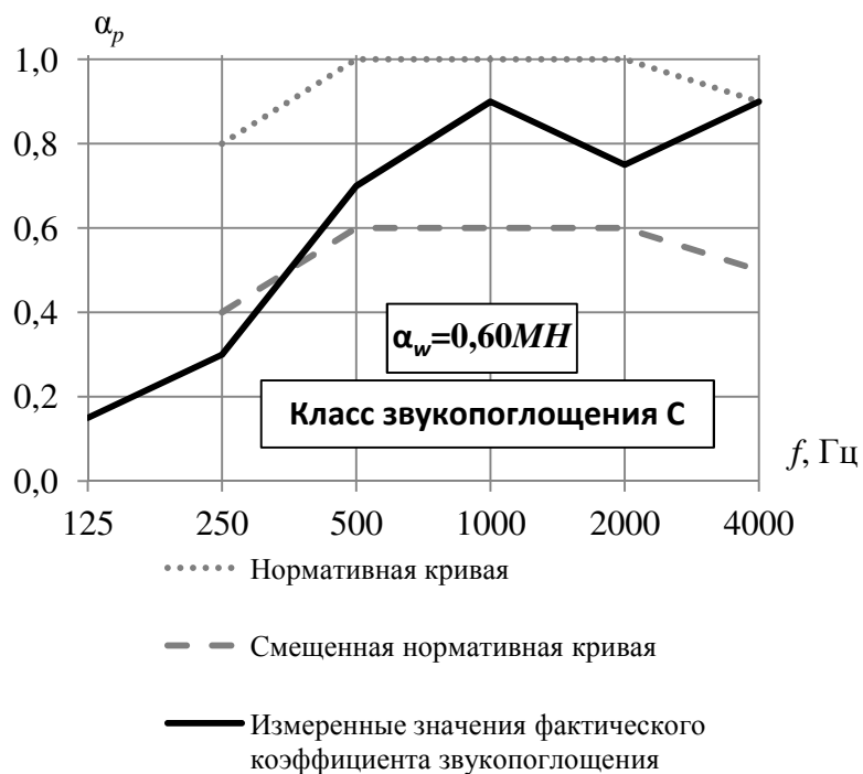
Рисунок 9 – Частотная характеристика фактического коэффициента звукопоглощения конструкции №2
