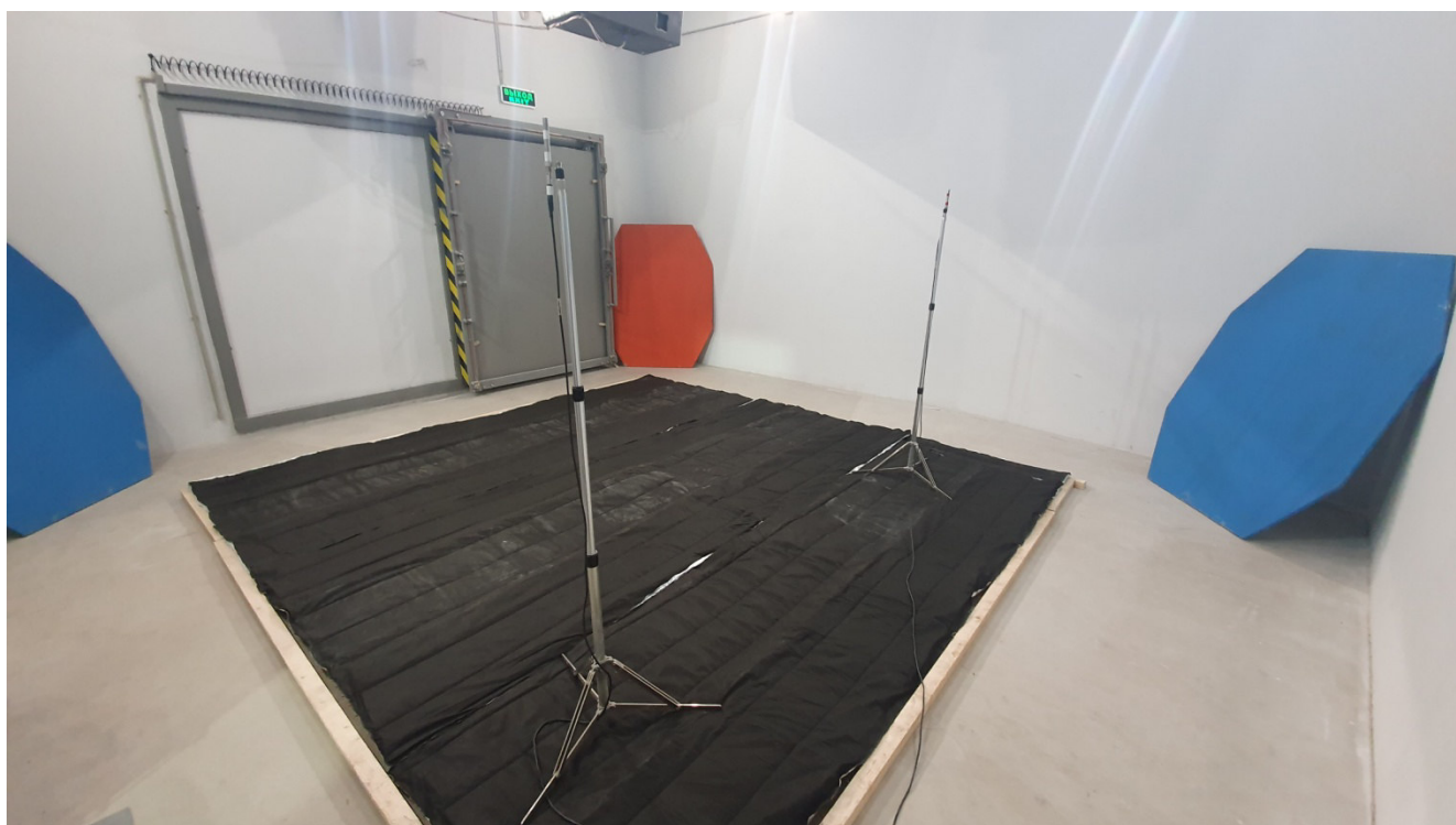
Рисунок 2 – Исследуемый образец №2, смонтированный на полу реверберационной камеры
