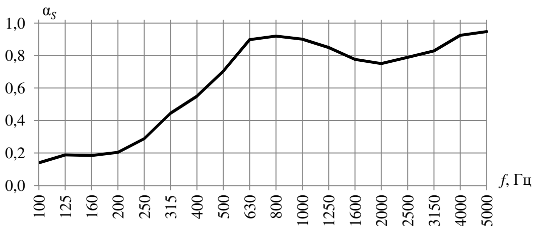
Рисунок 5 – Частотная характеристика коэффициента звукопоглощения конструкции №2
